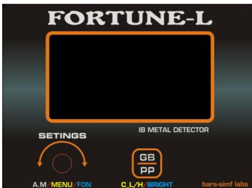
1. Металлодетектор «**FORTUNE-L**», работает по принципу VLF (Very Low Frequency), на частотах, от 5 до 31 кГц.
